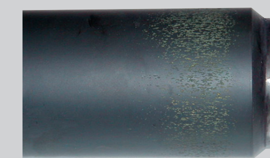
Beschädigung einer Walze durch ungleichmäßige Einstellung. Foto Böttcher.
