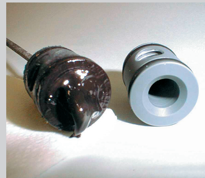
Ein mit Farbe verschmutztes Ausflussventil, hervorgerufen entweder durch die Verwendung des falschen Filters oder durch schlechte Wartung. Foto Technotrans.
