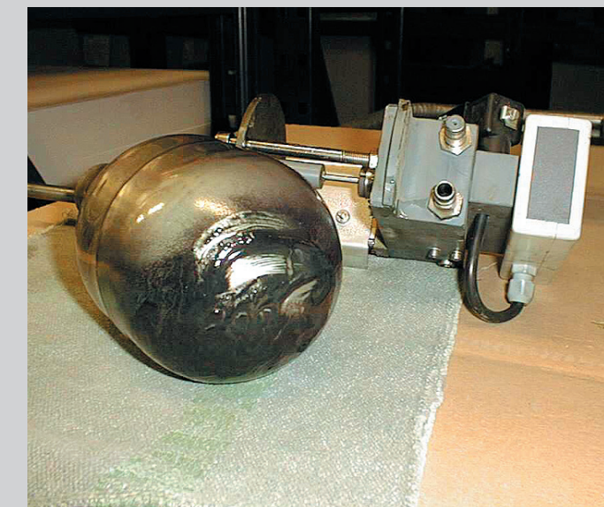
Schmutzablagerungen auf dem Alkohol-konstanthalter erhöhen dessen Gewicht und können den Alkoholgehalt im Feuchtmittel erhöhen. Foto Technotrans.
