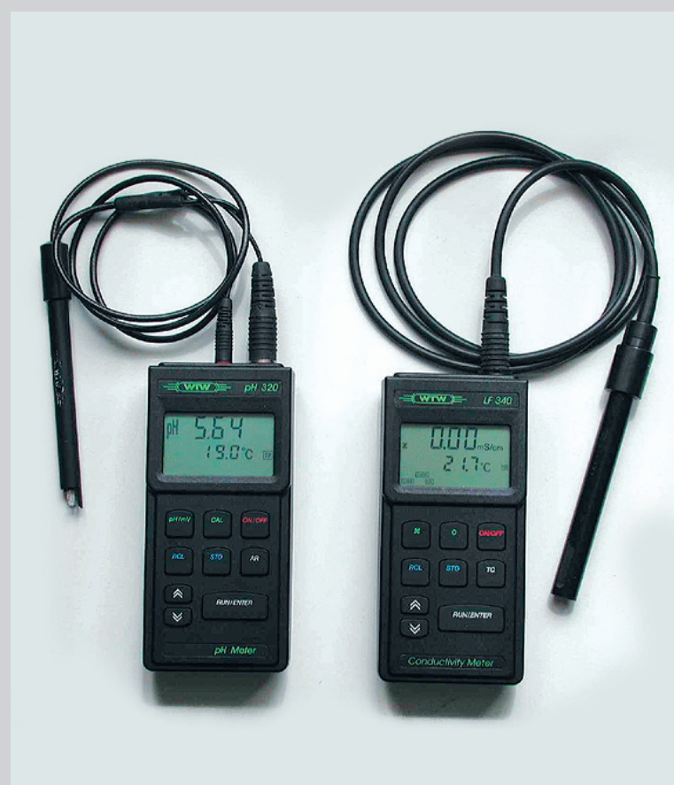
Zu den Überwachungsinstrumenten für das Feuchtsystem gehören elektronischer Leitfähigkeitsmesser, pH-Messgerät und Prüfthermometer (digitale Instrumente sind genauer und leichter zu eichen), ein Dichtemessgerät zur Bestimmung des IPA-Anteils und ein Test für die Wasserhärte. Foto Sun Chemical.
