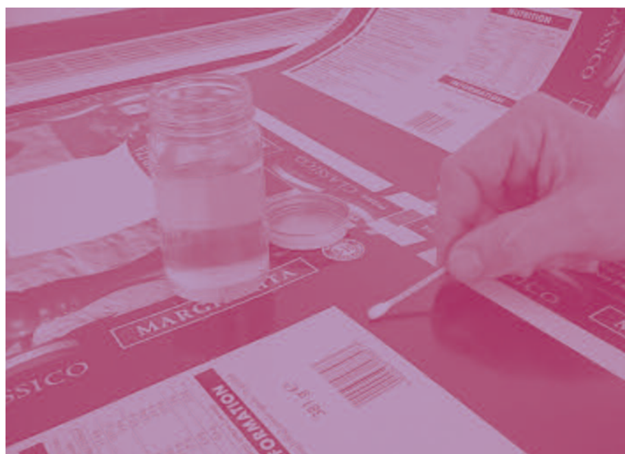
Il metodo tradizionale per verificare se i fogli stampati sono stati essiccati adeguatamente mette a raffronto la resistenza all'attacco dei solventi tra un campione stampato e un campione di prova standard.
