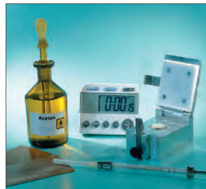
ACET è un tester semplice da utilizzare, sviluppato da FOGRA, per valutare la resistenza ai solventi.
