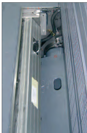
Essiccatore intermedio UV impiegato su una macchina da stampa Roland 700.
