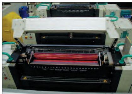
Copertura del calamaio aperta che mostra l'agitatore, il cui utilizzo serve per evitare che l'inchiostro UV ad alto tiro essicchi nel calamaio.
