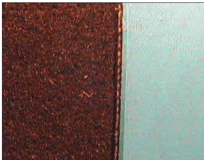
Superficie del tessuto gommatto spellicolabile: sono evidenti il lato di stampa superiore e la zona nera di contrografismo. Foto Trelleborg.
