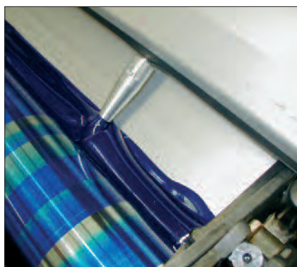
Gli agitatori dell'inchiostro sono consigliati per gli inchiostri UV che tendono a indurire ed a depositarsi nel calamai. Fonte: manroland.
